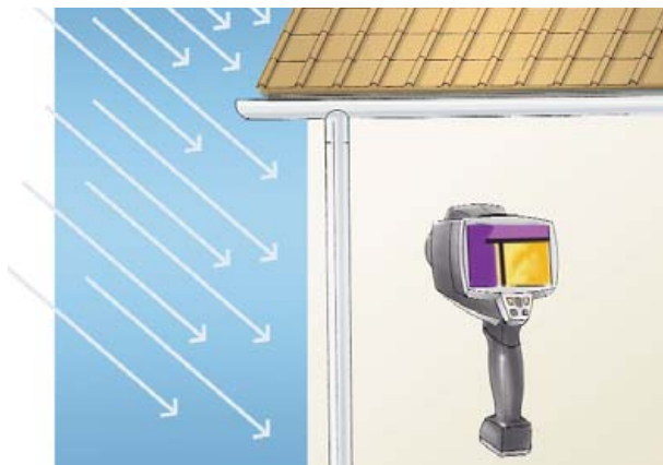
Bild 2.1: Reflektion vid utomhusmätning
