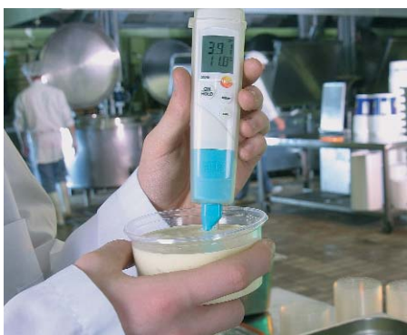
testo 206-pH2 är idealisk för mätningar i viskoplastiska ämnen.
