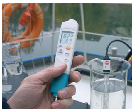
Automatisk temperaturkompensering tack vare externa givare med temperatursensor
