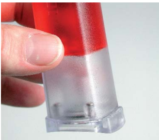
Kaliumkloridlösningen som bundits i gelmaterialet kan inte läcka.
