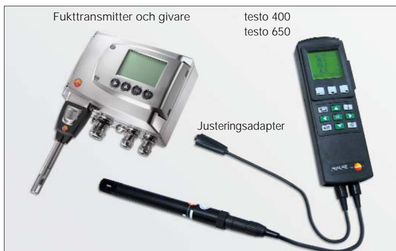
1-punktsjustering på platsen med något av de portabla instrumenten testo 400 eller testo 650, en precisionsfuktgivare och en justeringsadapter
