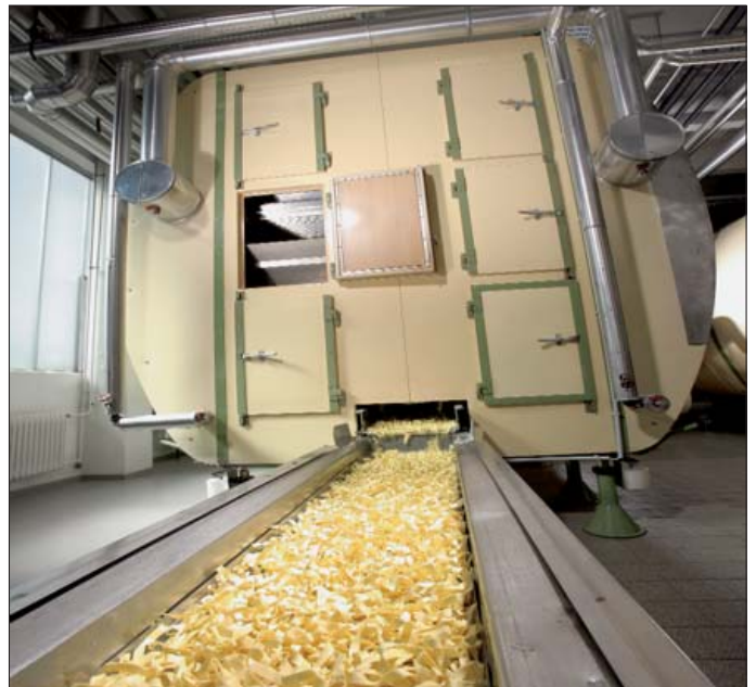
Vid pastatorkning måste fukthalten mätas
