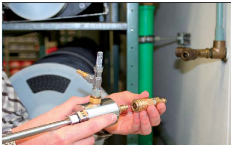
Anslutning av fuktgivaren för låga fuktvärden testo 6651 via mätkammare och skyddsfilter
