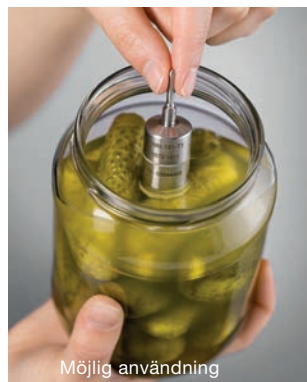
Temperaturmätning på burk: testo 191-T1 + stativ
