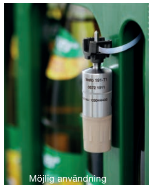
Temperaturmätning i en burk/flaska med loggern externt monterad: testo 191- T2 + burk- och flaskfäste
