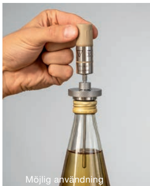
Temperaturmätning i en burk/flaska med loggern externt monterad: testo 191- T2 + burk- och flaskfäste
