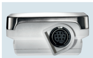
Givaranslutning nedtill på instrumenthuset för extern NTC-givare (endast testo 175 T2)
