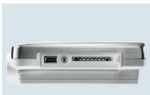
Sidoanslutning för mini-USB-kabel och SD-kort
