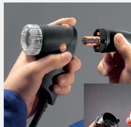
Byte av sondrör
