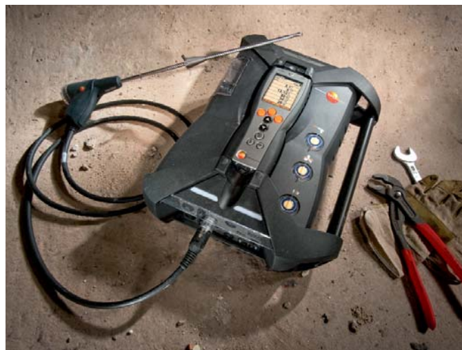
Robust rökgasmätare för industriellt bruk, även under de tuffaste förhållanden
