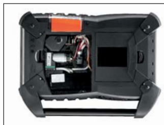
Serviceluckan gör det enkelt att komma åt slitagedelarna
