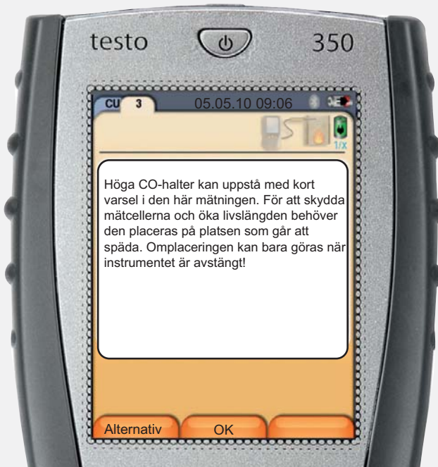
Exempel på visning i displayen på handterminalen diagnosfunktion och information i klartext
