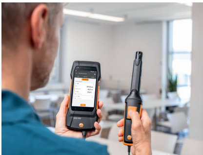
Fig. 1: Mätning av omgivningsluftens temperatur och luftfuktighet med hjälp av klimatinstrumentet testo 400.
