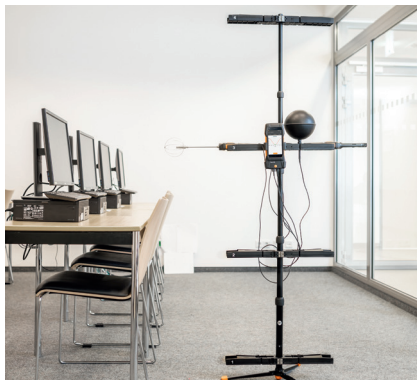
Fig. 5: En relativt snabb mätning räcker ofta för att få en uppfattning om de termiska förhållandena.
