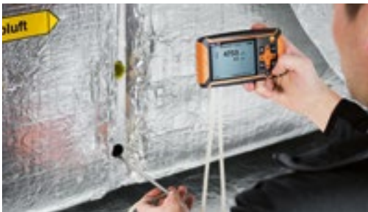
Löstagbart instrument medger mätningar med Pitotrör/ Prandtlrör i kanaler (pitotrör/prandtlrör säljs separat)
