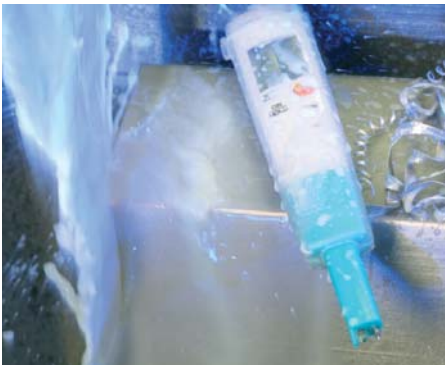
Fodralet TopSafe skyddar under krävande industriförhållanden
