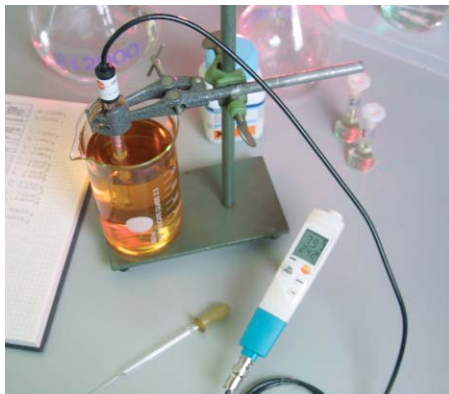
testo 206-pH3 gör det enklare att ansluta externa pH-givare
