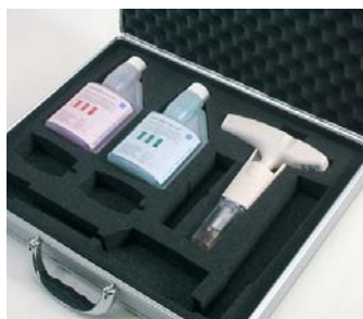
Mätsetväska med testo 205, buffertlösningar pH 4,0 och 7,0 samt förvaringskåpa
