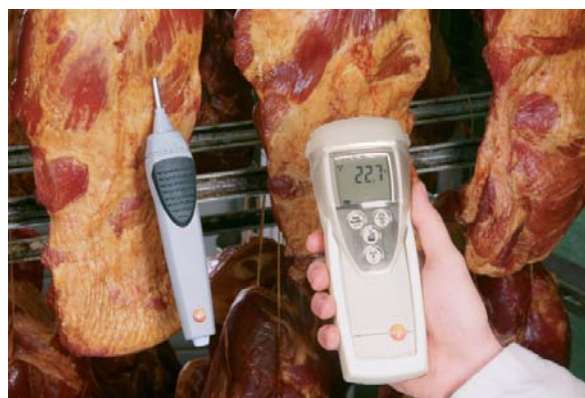
Insticksmätning av temperatur vid rökning av livsmedel, trådlös överföring av mätdata med radioteknik
