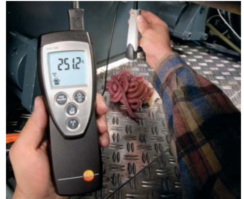
Temperaturmätning i formbara material med den supersnabba insticksgivaren, idealisk för plastmassa, livsmedel etc.
