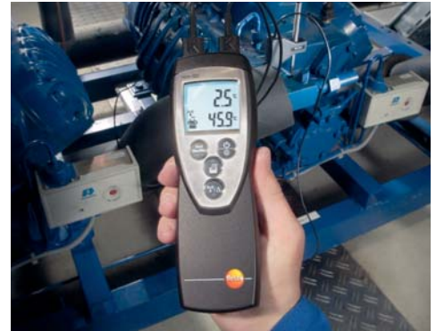
Samtidig mätning av överhettning och underkyllning i kylanläggningar
