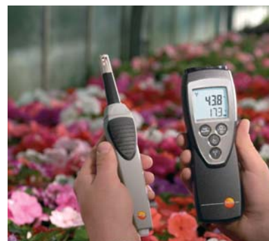
Plug-in-fuktgivare ansluten till ett radiohandtag, t.ex. för övervakning av klimatreglering
