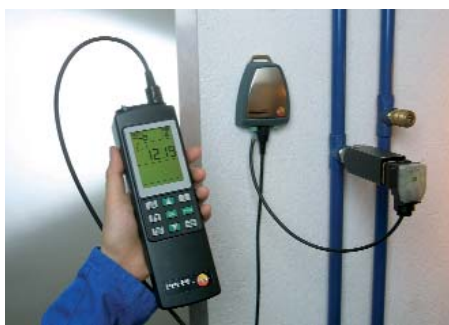
Precisionsinstrument för alla parametrar: provning av en transmitter med interface för 0/4 till 20 mA
