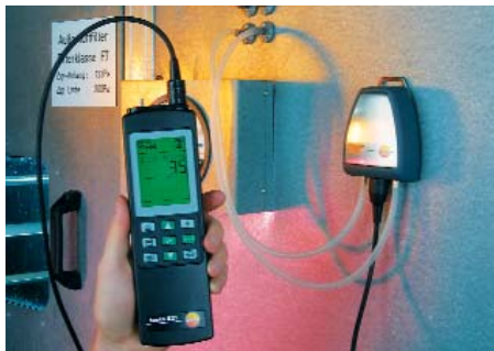
Precisionsinstrument för alla tryckområden: Mätning av differenstryck över ett filter med extern tryckgivare
