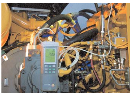
Samtidig mätning av trycknivå och temperatur i i hydraulsystem med externa givare
